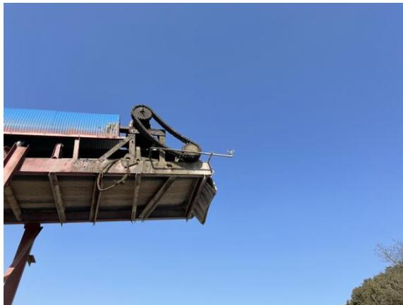
图 9.2-5 皮带机落料处喷淋装置
