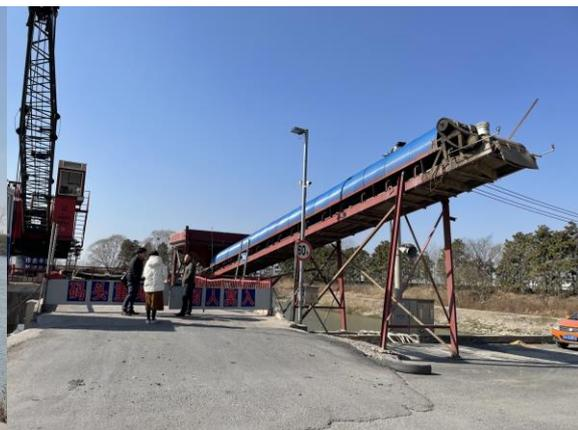
图 9.2-2 封闭皮带机
